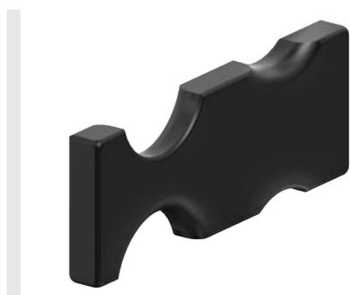
PolyVee 张紧装置能够轻松张紧 2 楔和 3 楔 PolyVee 皮带，适用于滚筒间距 75 mm 和 100 mm。该张紧装置针对直径为 50 mm 的滚筒和 RollerDrive 而设计。不能用于带管子套管或锥形元件的管子。
