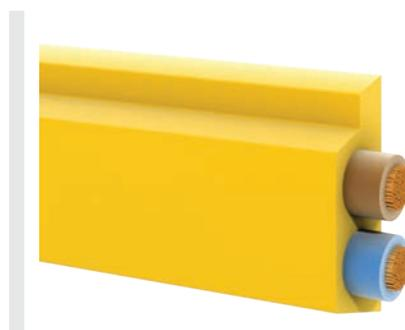
该扁平电缆用于 ConveyorControl 控制系统的通信。系统的不同控制装置只需通过穿透触点与线路接触。该线路的外轮廓对应于 AS 接口的标准。该线路的外管覆盖由穿透接触形成的孔。这意味着即使断开控制装置后，电缆也可保持原有防护等级。
