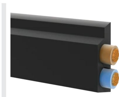
该扁平电缆用于 ConveyorControl 和 MultiControl 的电压供应。该线路的外轮廓对应于 AS 接口的标准。该线路的外管覆盖由穿透接触形成的孔。这意味着即使断开控制装置后，电缆也可保持原有防护等级。
