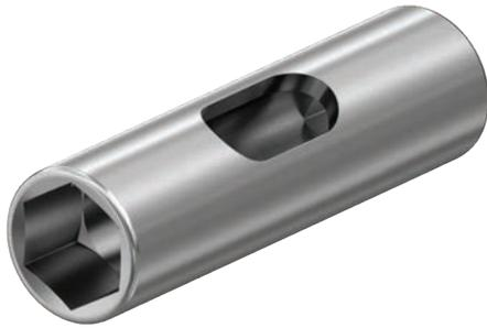
紧固凹头螺丝用于使用扭矩扳手根据 RollerDrive 紧固螺母的扭矩进行紧固。凹头螺丝具有侧面开口，RollerDrive 连接电缆可通过此开口向外馈送。
