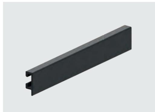
侧导轨 用于可靠引导滚筒输送机 and 皮带输送机上的产品以及相关部件。特别是，由于采用柔性材料（聚合物），因此导轨可调节以适应物料流的转弯、合流和分流。
